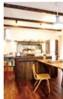
【熊谷市I邸】 純和風の日本家屋を、アジアの香り漂う「和モダン」をテーマにリフォーム。天井を高くし、出てきた梁はインドネシア製の輸入家具の色と合わせて自然塗料で濃茶に塗装。床は桐の無垢材、壁と天井は珪藻土の塗り壁など、自然素材をふんだんに使用
