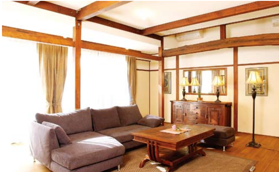
【熊谷市I邸】 純和風の日本家屋を、アジアの香り漂う「和モダン」をテーマにリフォーム。天井を高くし、出てきた梁はインドネシア製の輸入家具の色と合わせて自然塗料で濃茶に塗装。床は桐の無垢材、壁と天井は珪藻土の塗り壁など、自然素材をふんだんに使用
